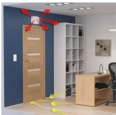
Ejemplo de "elemento de tránsito activo": Un ventilador introduce aire fresco del corredor en el recinto. El aire utilizado vuelve al corredor a través del hueco bajo la puerta.
