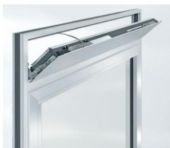
3. Ejemplo de inyección de aire desde el exterior a través de la apertura automática de la ventana (no se recomienda en zonas urbanas debido al ruido y a la contaminación del aire). La apertura de la ventana debe controlarse para que se abra al mismo tiempo que se pone en marcha el sistema de extracción de aire.
