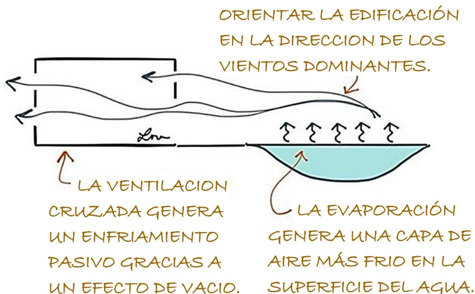
Figura 13 Esquema de refrigeración pasiva por humidificación Fuente: AREsketches
