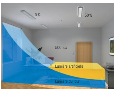
Le système de gestion de l'éclairage dose automatiquement l'éclairage artificiel en fonction de l'apport en lumière naturelle.
