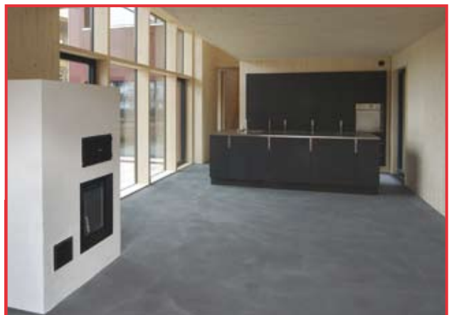
Viel Licht erfüllt den Wohnraum im Erdgeschoss. Der gemauerte Speicherofen ist die einzige Wärmequelle des Hauses.
